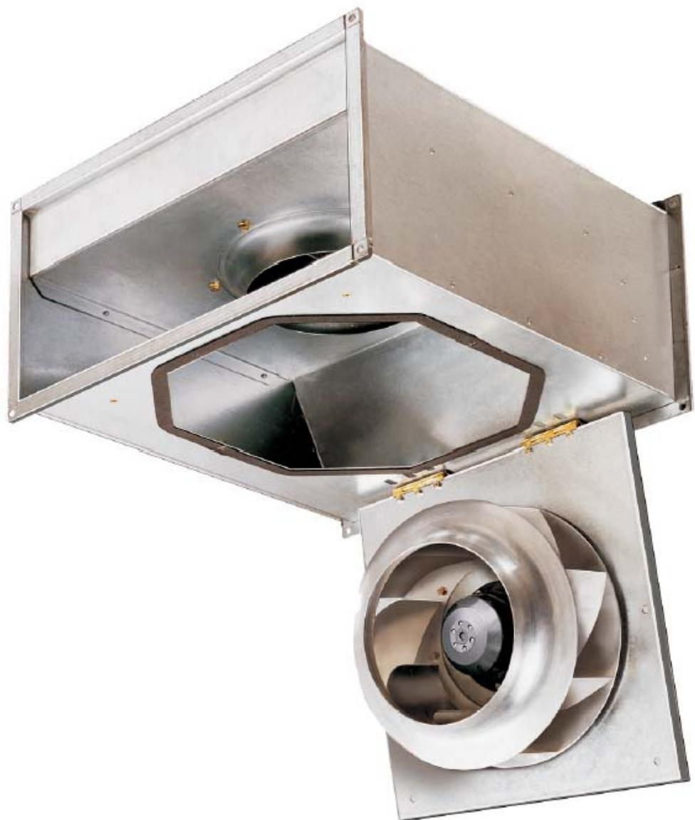
Канальные вентиляторы объединяют в себе такие преимущества осевых вентиляторов как прямолинейность потока воздуха и простота монтажа с большим постоянством давления, низким уровнем шума и необычайно большим коэффициентом полезного действия центробежного вентилятора.
