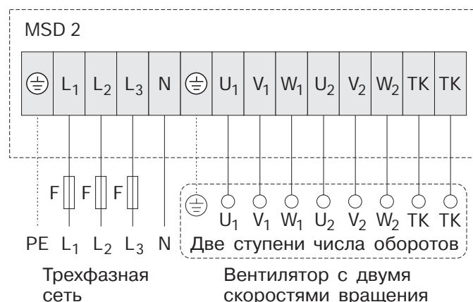
Коммутационный аппарат двухскоростной для электродвигателей трехфазного тока с двумя скоростями вращения (по схеме Даландера).
