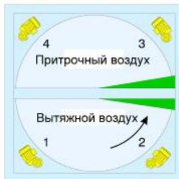
Пример положений двигателя и продувочного сектора
